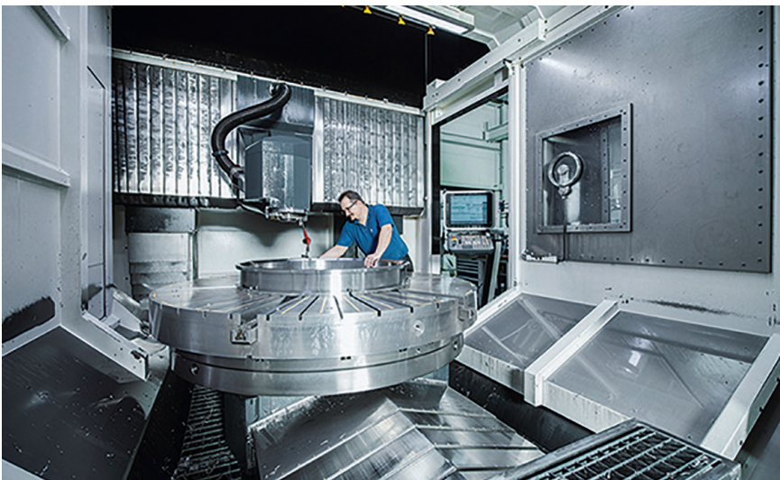
1 XXL-Bauteile für große Computertomographen bearbeitet Franke auf der DMU 210 FD
